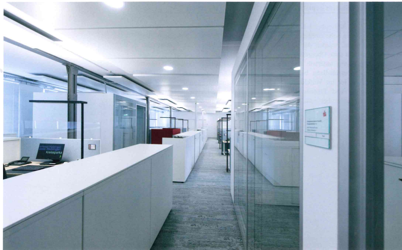
▲ In den Open-Space-Bereichen tragen akustisch hochwirksame Decken- und Wandabsorber wesentlich dazu bei, störenden Nachhall zu beseitigen
