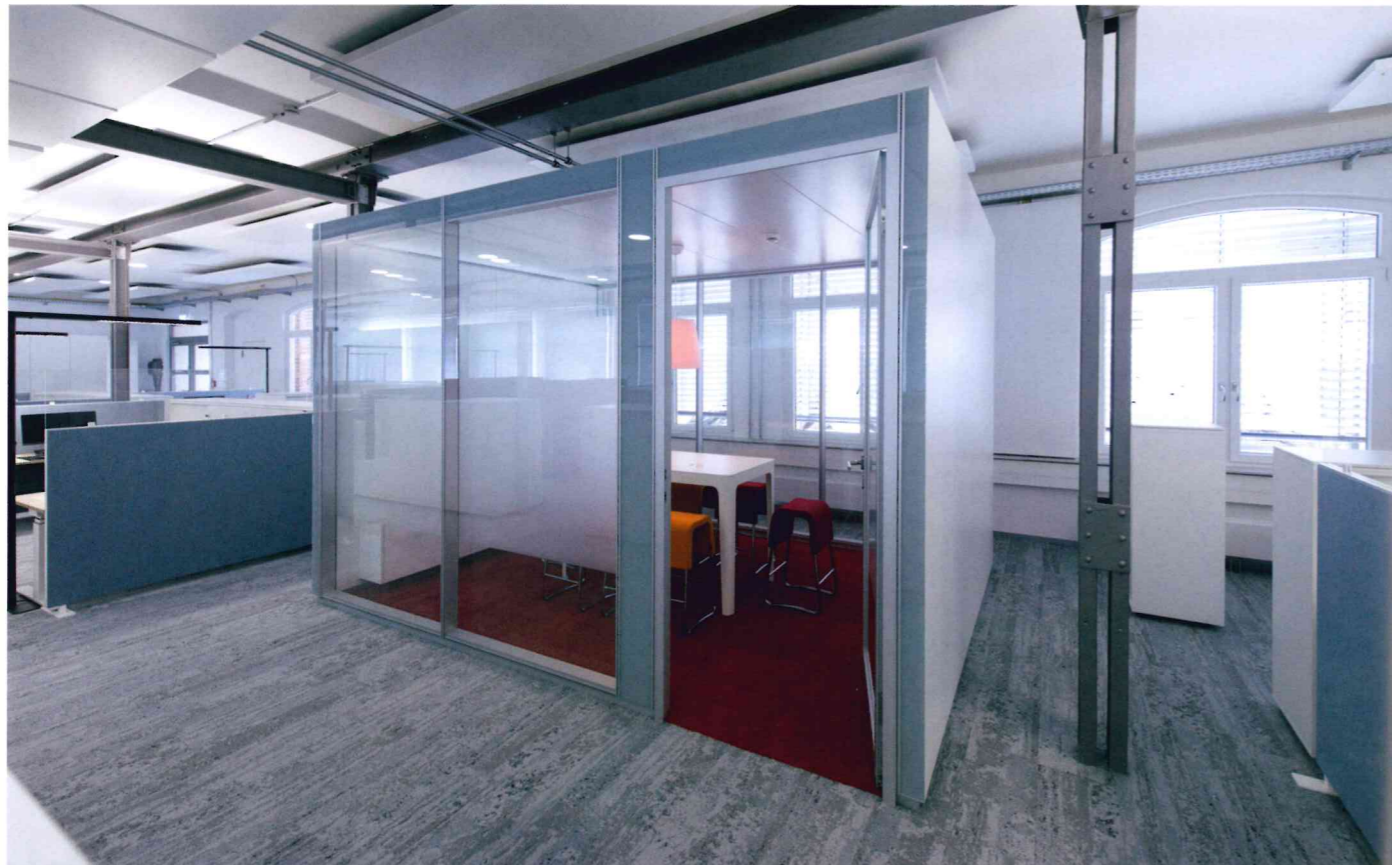
▲ Durch die überwiegend offene Bürogestaltung und den Einsatz von Raum-in-Raum-Systemen ist die attraktive Stahlträgerkonstruktion der ehemaligen Maschinenfabrik sichtbar
