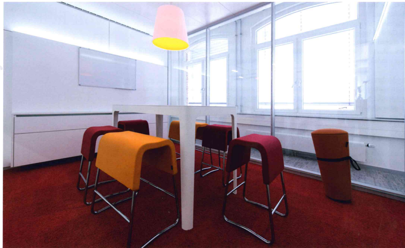
▲ Die Raum-in-Raum-Systeme unterstützen durch ihre raumakustische Qualität konzentriertes Arbeiten und sorgen für Vertraulichkeit. Dank des Be- und Entlüftungselements und der autarken Kühleinheit herrscht in den Räumen stets ein angenehmes Klima
