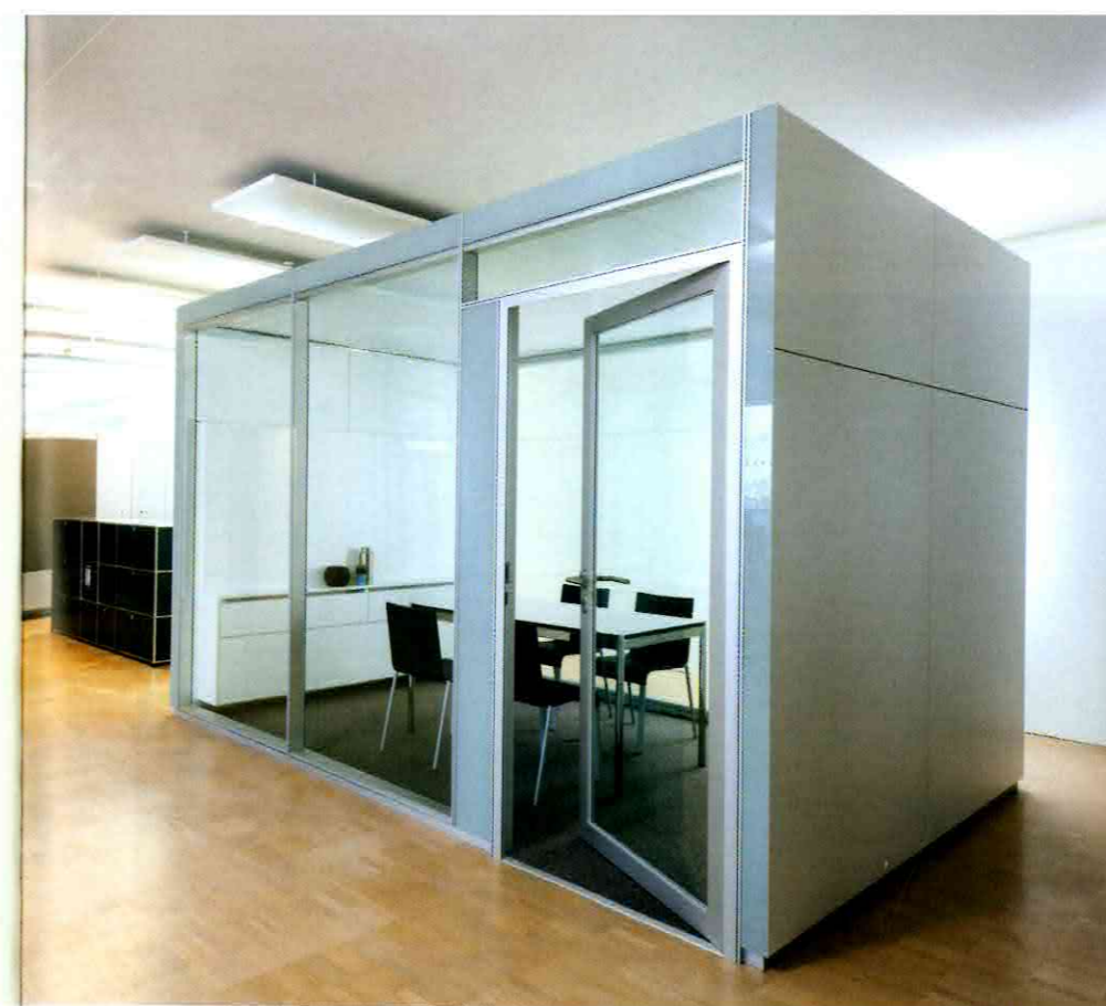
Raum-in-Raum. Das Trennwandsystem MTS mit seiner Pfosten-Riegel-Konstruktion mit nur 25 mm Ansichtsbreite bildet auch die Basis für den „Kubus“, der mit verdeckter Klimatisierung versorgt wird.
